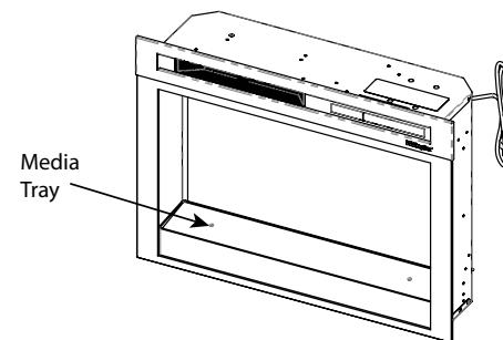
2a. При установке камина Dimplex в специальном кожухе сначала проверьте, имеются ли в нем отверстия сверху в боковых панелях, как показано на рисунке ниже. Если они имеются, выровняйте лицевую сторону камина (без стекла) по отношению к передней поверхности кожуха. Установите винты из комплекта поставки в передние отверстия во внутренних поверхностях камина. Винты должны попасть в отверстия в кожухе, которыедерживают их на месте.
