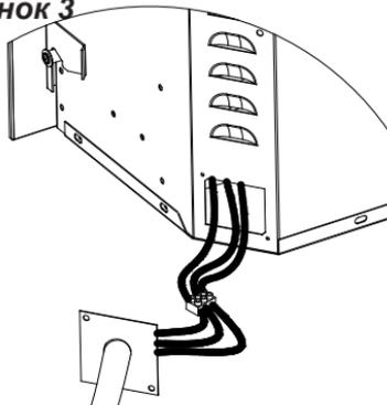
коробки и надежно зафиксируйте ее крышку на камине. Убедитесь, что кабельный зажим прижимает только оболочку кабеля.
